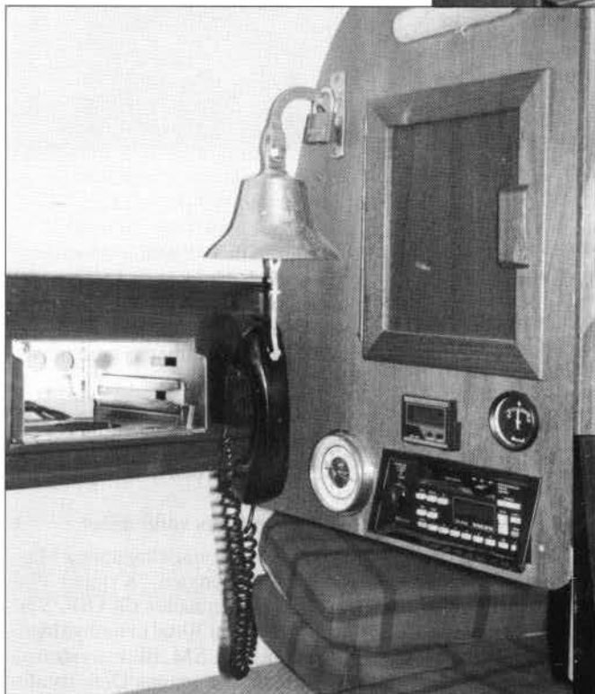
Två mobiltelefoner, som drivs med solenergi, bakom luckan finns säkringarna för elsystemet. En ampèremätare och lite annat smått och gott. Den stora apparatpanelen är helt enkelt en vanlig stereo.
